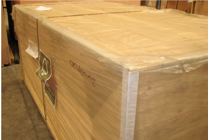
Imagen 9. Forma correcta de almacenamiento de tarimas de paneles en el local del distribuidor. Nótese el plástico que envuelve toda la tarima
