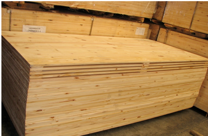
Imagen 8. Forma correcta de apilado de las láminas en el taller. Nótese la posición y grosor de los separadores
